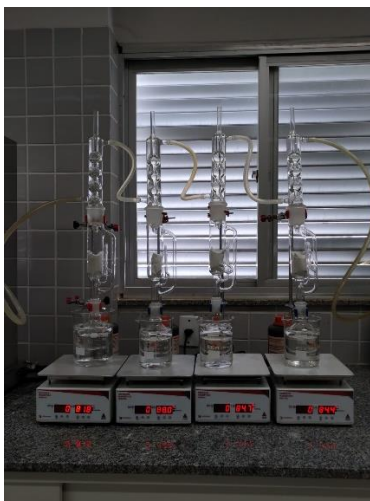
Figura 11: Sistema Soxhlet para extração de óleo.
