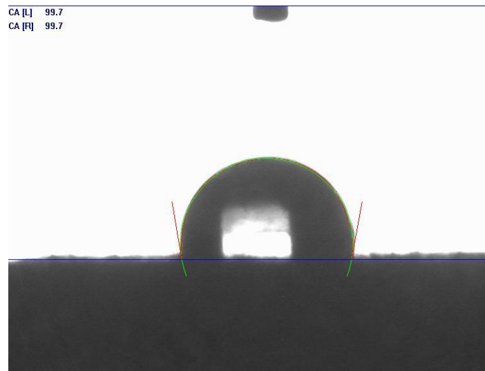
Figura 8: Formação da gota d'água para análise do ângulo na superfície da pastilha.
